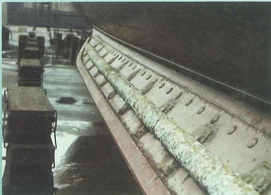
ビルジキールに取付けられた防食アルミ陽極群(昭和40年初期の船)
